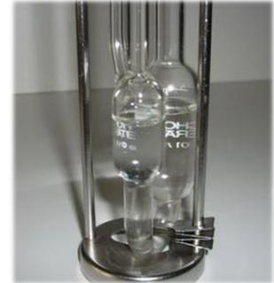
Im Polymerbereich wird die Kapillarviskosimetrie zur Bestimmung der Viskositätszahl und der Intrinsischen Viskosität sowie des K-Werts benutzt. Mit diesen Werten lässt sich das Molekulargewicht ermitteln, welches eine der wichtigsten Größen zur Charakterisierung von Polymeren ist.
